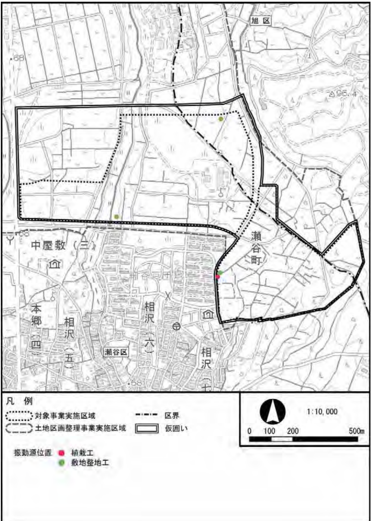
図 6.10-3(1) 建設機械配置 (本事業)
