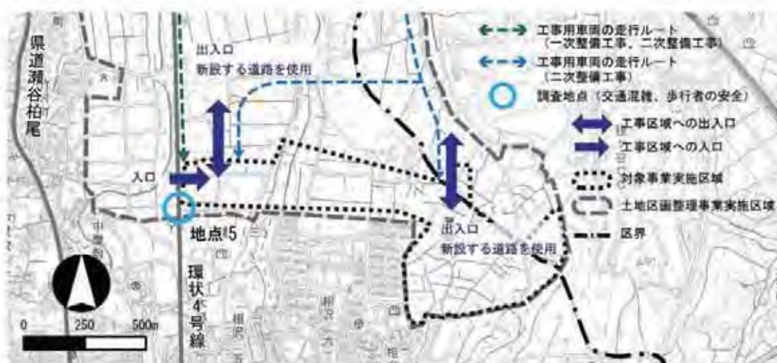
図 9-2 二次整備工事時の工事用車両の工事区域の出入口
