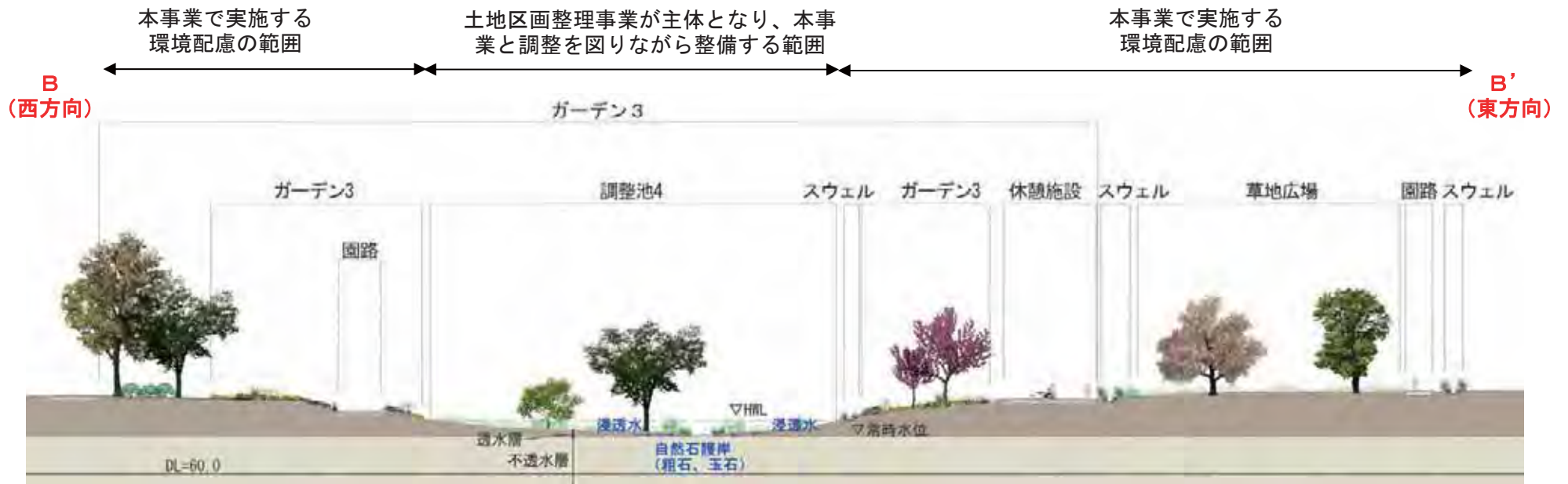
図 6.2-25(2) 地上式調整池（調整池4）の縦断模式図（B-B'断面）
